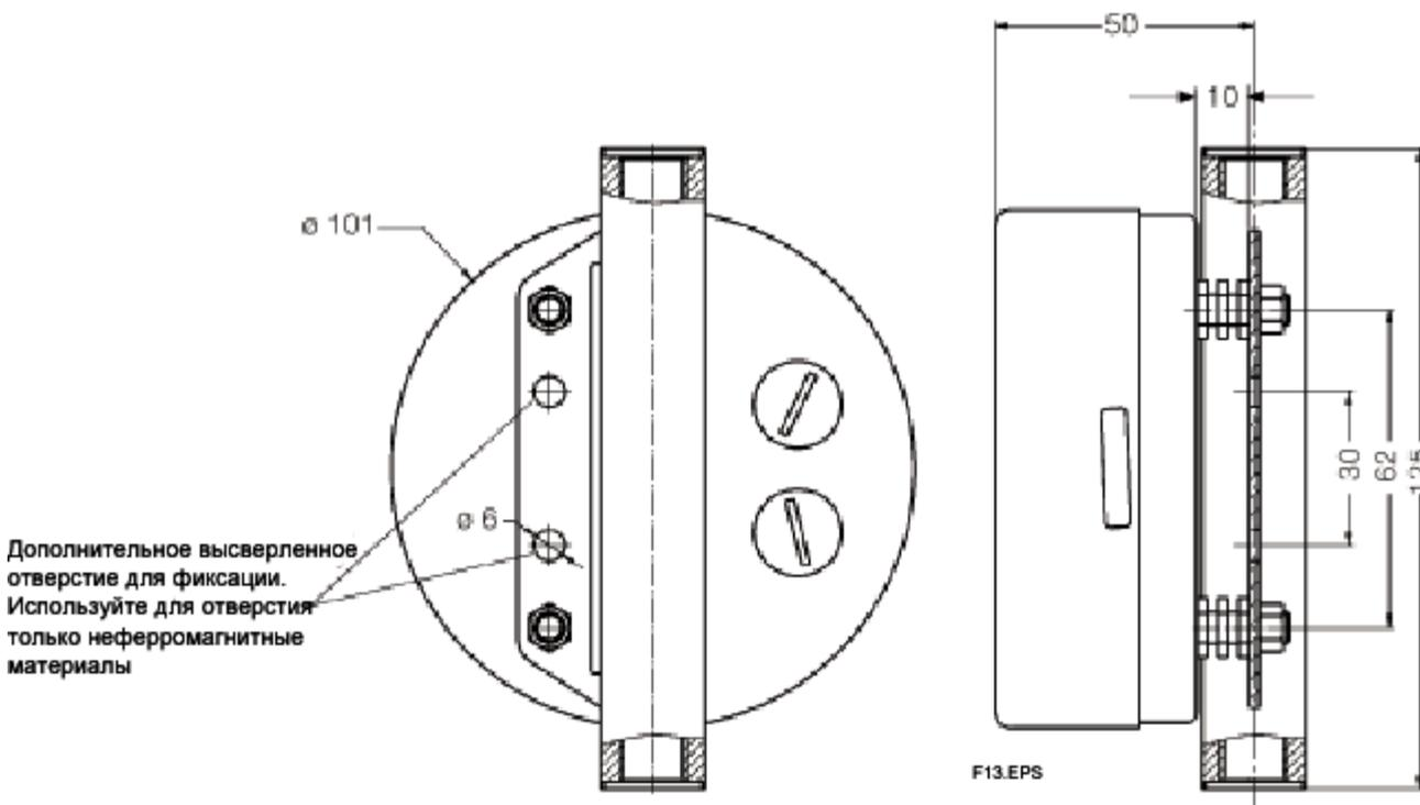
Рис. 9. Вид сзади с фиксацией
