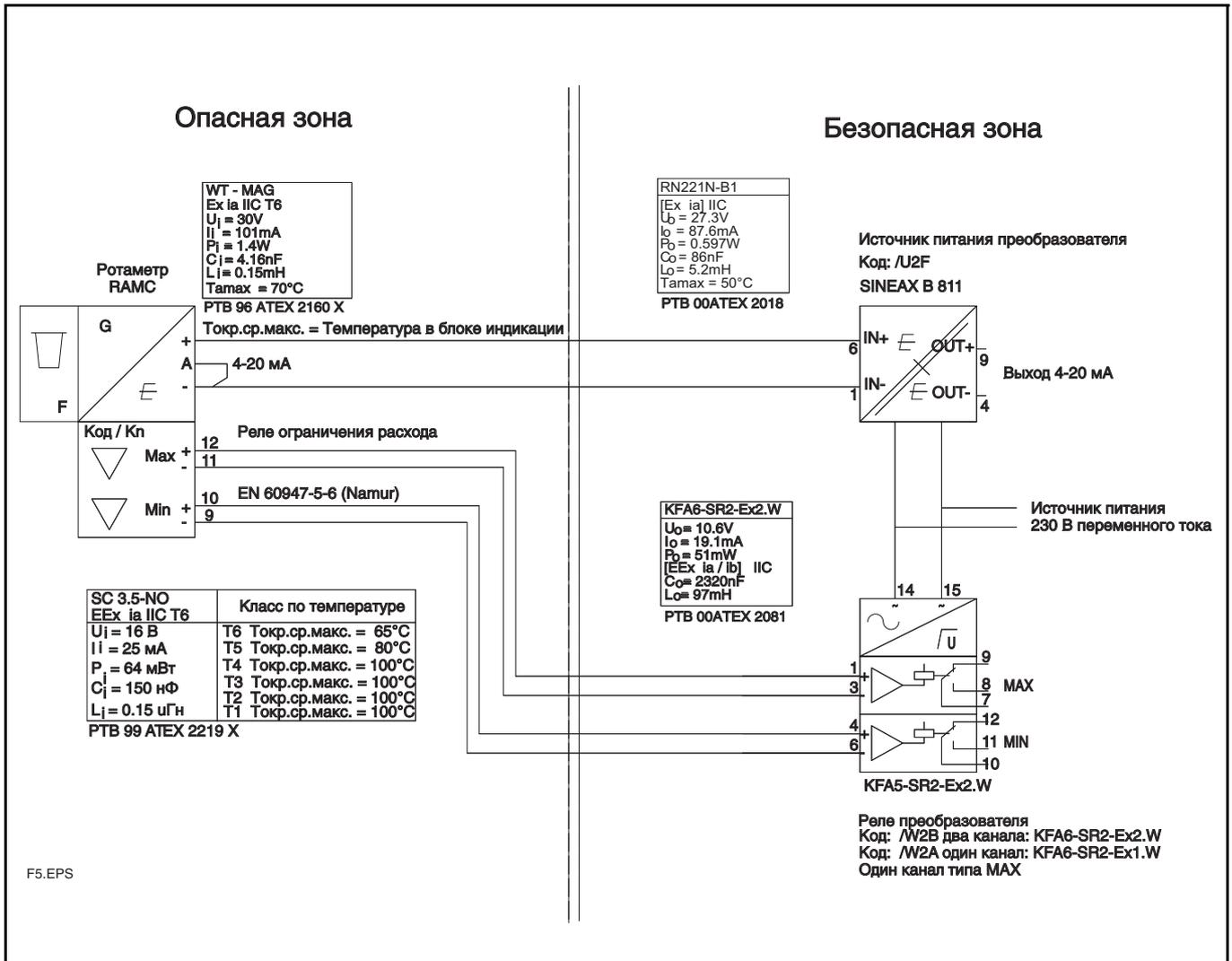
Рис. 5. АТЕХ-вариант RAKD с электрическим преобразователем с источником питания плюс реле ограничения расхода или импульсный выход в сочетании с реле преобразователя
