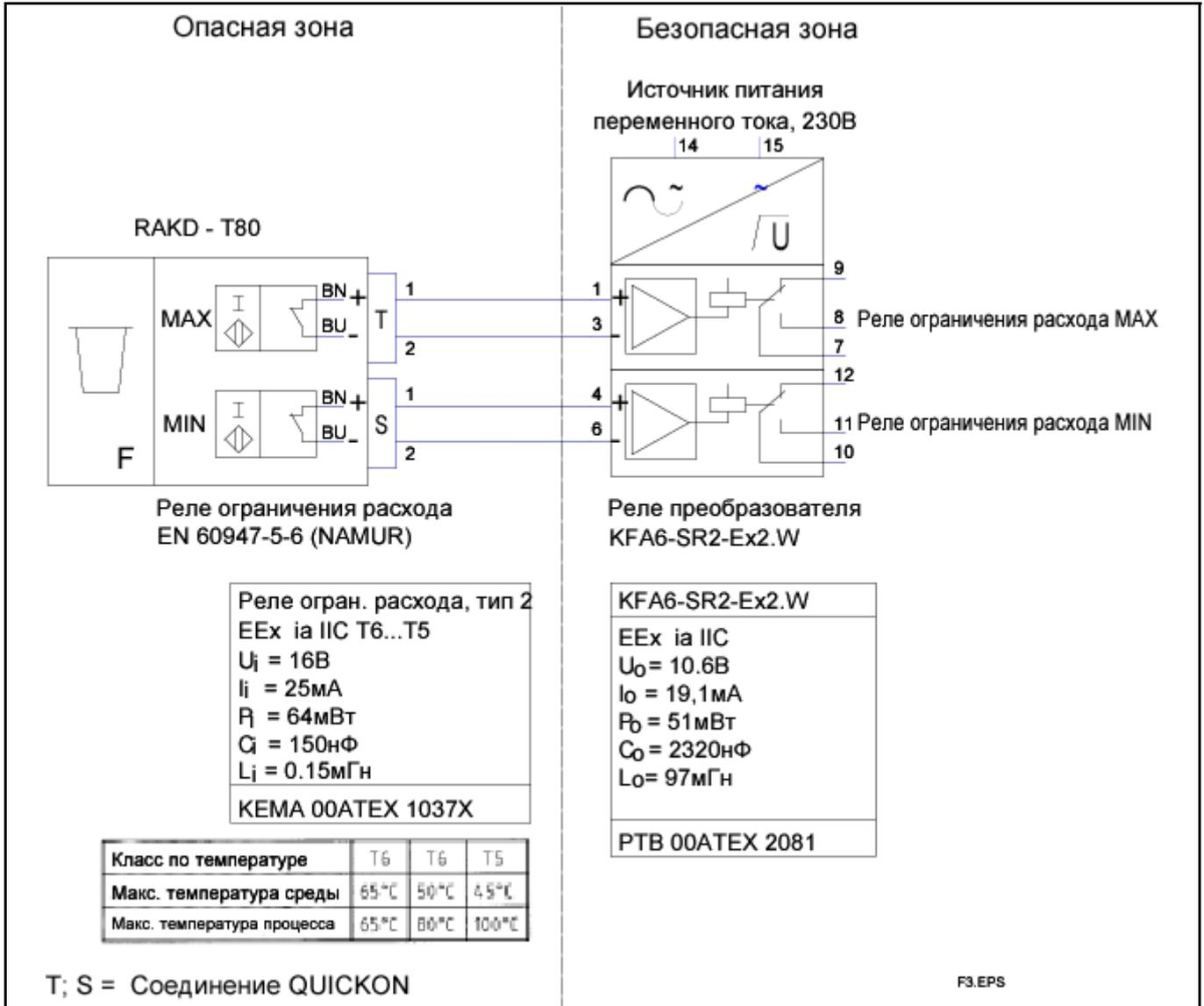
Рис. 3. АТЕХ-вариант: RAKD с двумя реле ограничения расхода в сочетании с реле преобразователя
