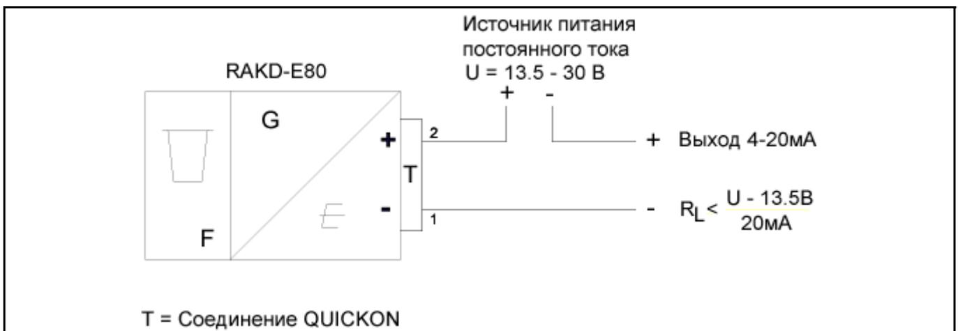
Рис. 4. RAKD с электронным преобразователем
