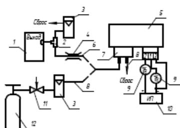
а) для газоанализаторов ДАХ-М-01-Н<sub>2</sub> S-40 ДАХ-М-01-SO<sub>2</sub>-20,
