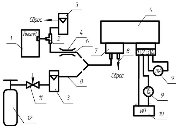
в) для газоанализаторов ДАХ-М-05-Н<sub>2</sub>S-40, ДАХ-М-05-SO<sub>2</sub>-20,
