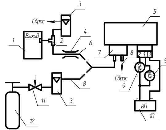
б) для газоанализаторов ДАХ-М-04-Н<sub>2</sub>S-40, ДАХ-М-04-SO<sub>2</sub>-20,
