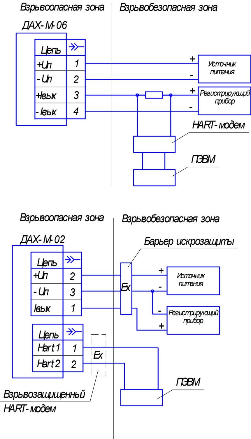
Рисунок 2.3 – Схема подключения HART-совместимого оборудования к газоанализаторам ДАХ-М-02, ДАХ-М-06
