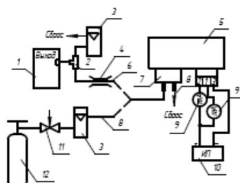
б) для газоанализаторов ДАХ-М-04-Н<sub>2</sub> S-40 ДАХ-М-04-SO<sub>2</sub>-20,
