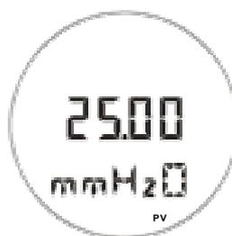
**Рисунок 2.6 – Типичный дисплей в режиме мониторинга, показывающий PV, в данном случае 25.00 мм Н<sub>2</sub>О**
