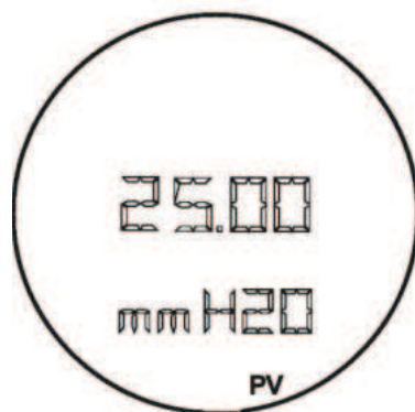
Рисунок 2.5 – Типичный дисплей в режиме мониторинга, показывающий PV, в данном случае 25.00 мм H 2 O
