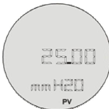
Рисунок 25 – Типичный дисплей в режиме мониторинга, показывающий PV, в данном случае 25.00 мм H<sub>2</sub>O
