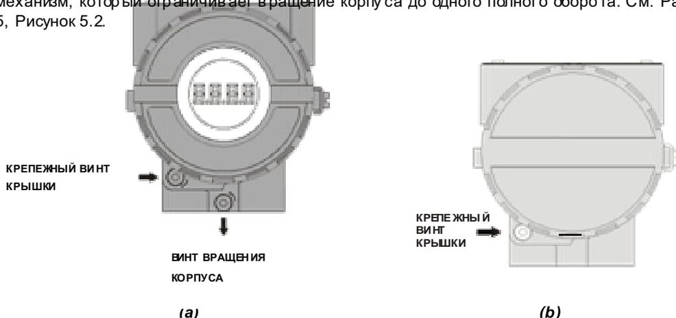
**Рисунок 1.4 – Крепёжный винт и винт вращения корпуса**
