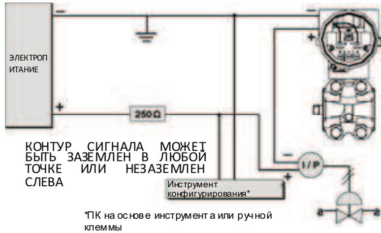
Рисунок 1.8 - Схема электропроводки для LD301, работающего в качестве контроллера
