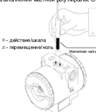
Рисунок 4.2 – Отверстия и переключатели местной регулировки нуля и шкалы
