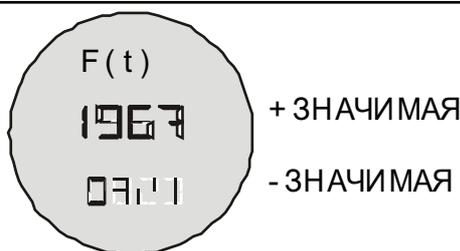
**Рисунок 3.6 – Типичный дисплей в режиме мониторинга, показывающий сумму, в данном случае 19.6708.23**
